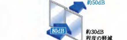
遮音サッシイメージ図 約50dB 約30dB 程度の軽減
