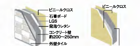
外壁構造図 戸境壁構造図
