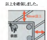
コンクリートかぶり厚断面イメージ図
